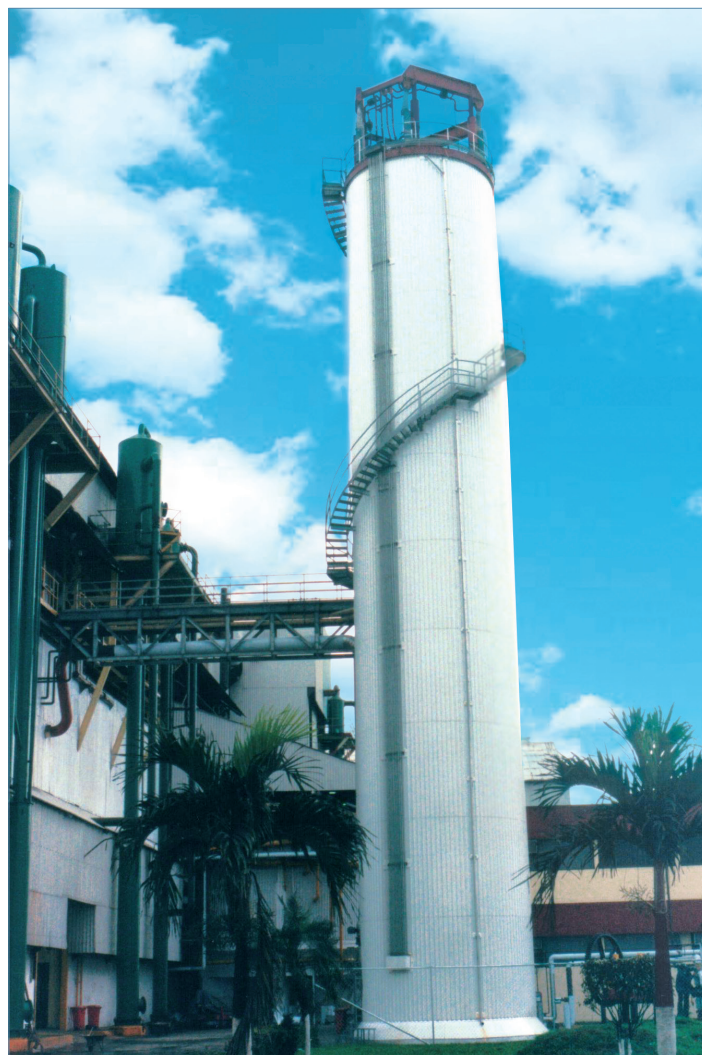
Figure 4 : Cristalliseur refroidisseur vertical de type oscillant OVC Sucrierie Puga Mexique
