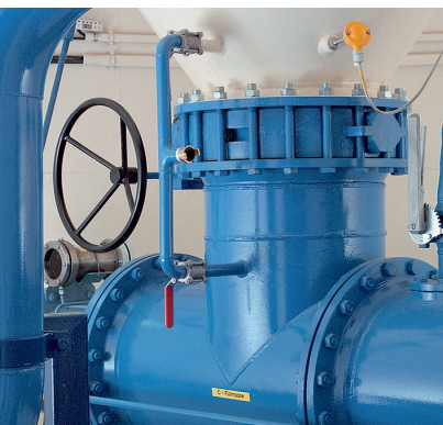
Смеситель, установленный непосредственно на выходе из кристаллизатора-охладителя
